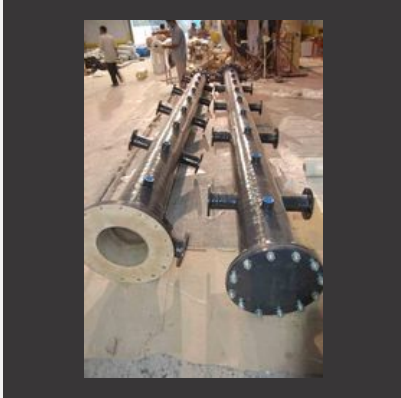
FRP Header Pipes
